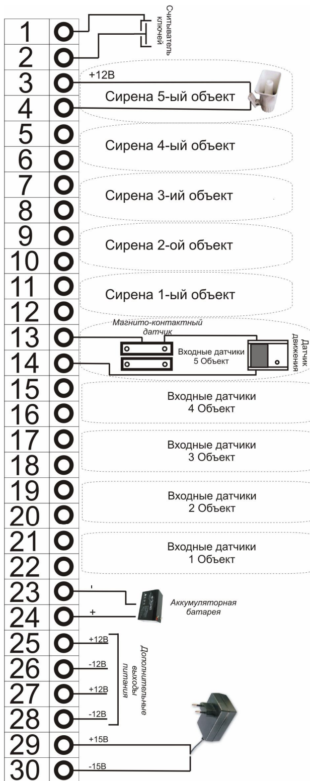
Рисунок 11. Типовая схема подключения Информатора
